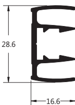
Mata junta lateral MG20-153 0,346 Kg/m
